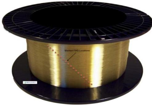
FBG(ファイバブラッググレーティング)は、光ファイバ素線に、広い波長域に多点でセンサーを直接書き込むことが可能です。光ファイバ自体に書き込んでいるので、スペースが限定された場所でも、複数の箇所に多点計測をすることが可能です。光ファイバの被服も用途に応じて、Acrylate、ポリイミド、金コート等からご選択頂くことができます。センサーは、波長-温度、波長-歪みの優れたリニアリティを有しています。ミリ秒の応答速度を有しており、実験・商用のアプリケーションで、プロセスフィードバック・制御に役立ちます。既存の歪みセンサーや温度センサーと同等の感度を有しており、電磁干渉ノイズにも影響を受けずに計測ができます。
