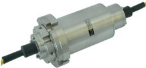
MXnシリーズは多芯チャンネルの光ロータリジョイントとしては最小のサイズでご提供できます。MXnシリーズでは4-7chまで対応しております。各チャンネルは独立した信号を途切れることなく送受信できます。電気スリップリングやRF信号用のロータリジョイントと組み合わせてご利用頂けるので、限られたスペースでもご使用頂けます。(電気スリップリング・RF信号用ロータリジョイ
